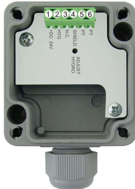
Die Abschirmung (SHIELD) ist optional zu belegen. Anschluss über geschirmte Leitungen ist zu empfehlen. Der PT1000 ist potentialfrei durchgeschleift, mit 2-Leiteranschluss. Der Leitungswiderstand ist zu kompensieren. Auf Wunsch sind auch andere Messwiderstände, beispielsweise NTC-Widerstände, möglich!
