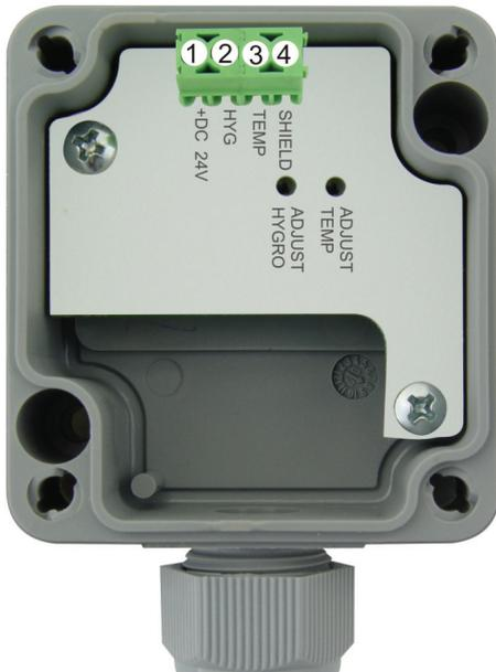
Die Abschirmung (SHIELD) ist optional zu belegen. Anschluss über geschirmte Leitungen ist zu empfehlen. Betriebsspannung +DC 24 V ist für beide Messwandler gemeinsam.
