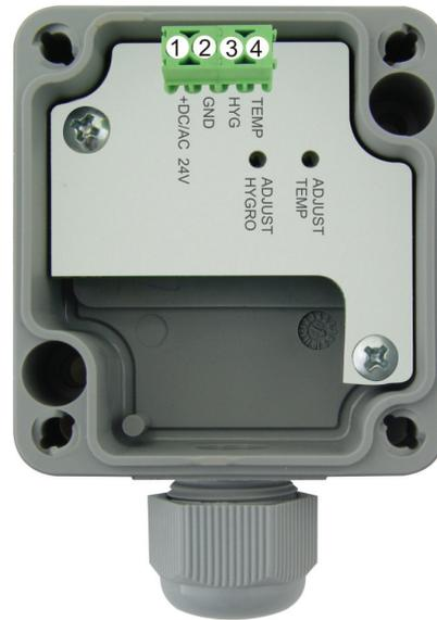
Temperatur und Feuchte jeweils auf GND bezogen, Betriebsspannung +DC/AC 24 V ist für beide Messwandler gemeinsam. Die Messung des Ausgangssignals sollte mit separater Signalmasse erfolgen, um Messfehler durch Spannungsabfall an der Versorgungsmasse zu vermeiden.
